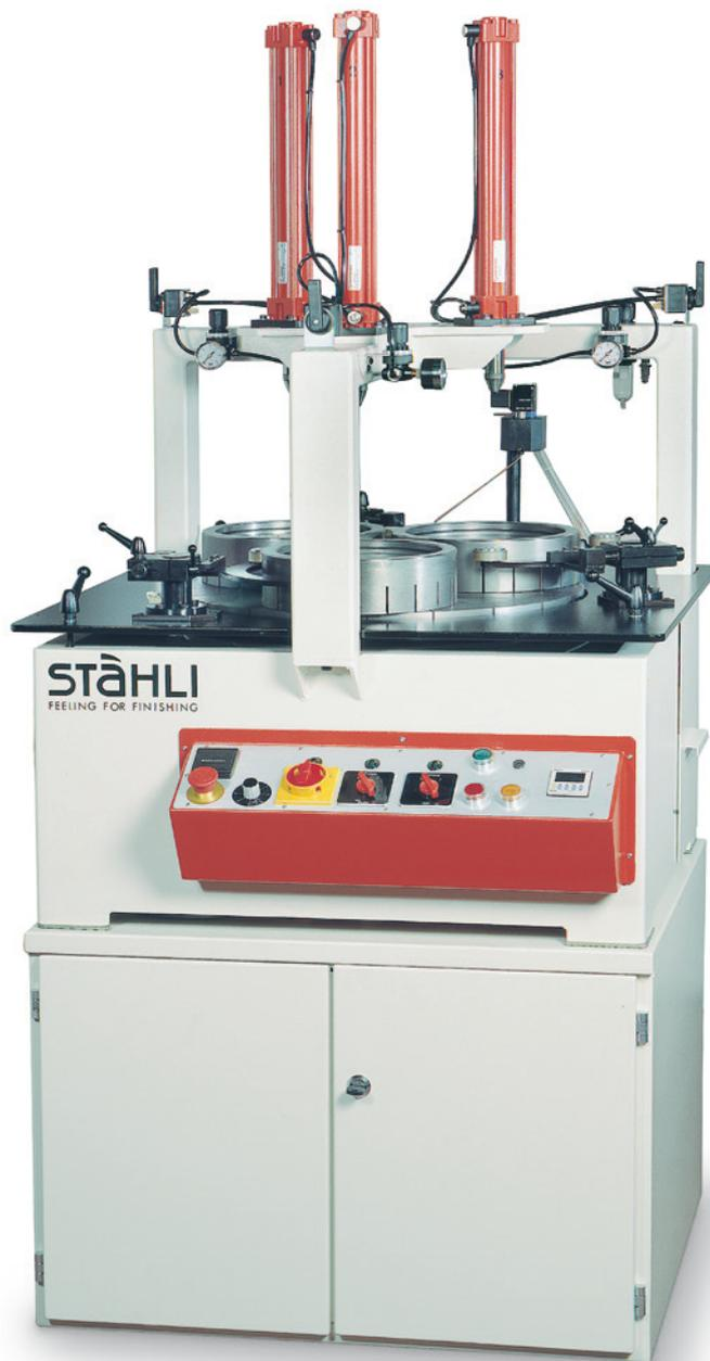
Bei der Produktion von kleinen bis mittleren Werkstücken stehen oft absolute Präzision, überdurchschnittliche Qualität und Wirtschaftlichkeit im Vordergrund. Anforderungen, denen unsere Stähli Baureihe FLM 500 und 550 voll und ganz gerecht wird. Läppen oder Polieren mit losem Korn oder Flachhonen mit Festkornscheiben - unsere Stähli Baureihe
