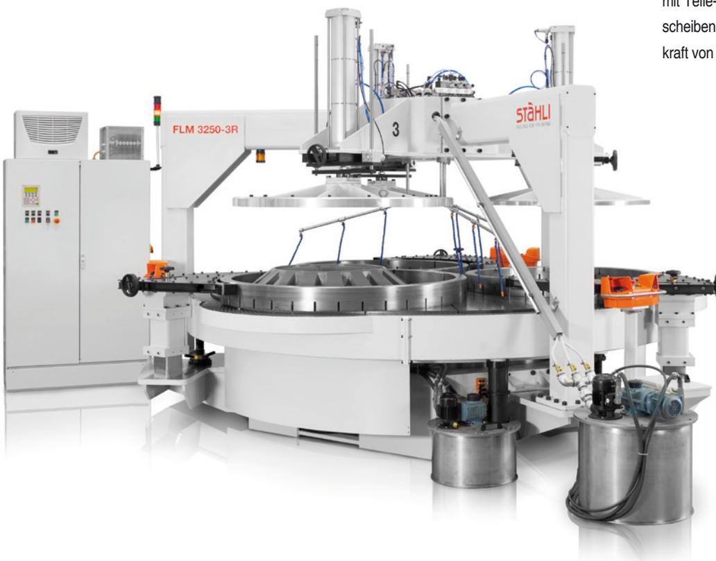
Grosslappmaschine für jegliche Läpparbeiten mit Teile-Durchmesser bis 1500 mm, Arbeits-scheiben-Durchmesser 3250 mm und Arbeitskraft von bis zu 750 daN.
